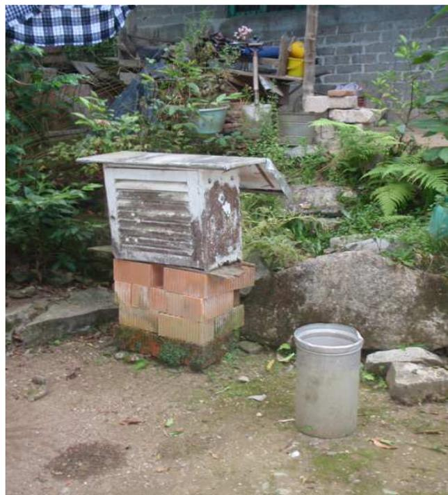
Vista del abrigo termométrico y el pluviómetro
