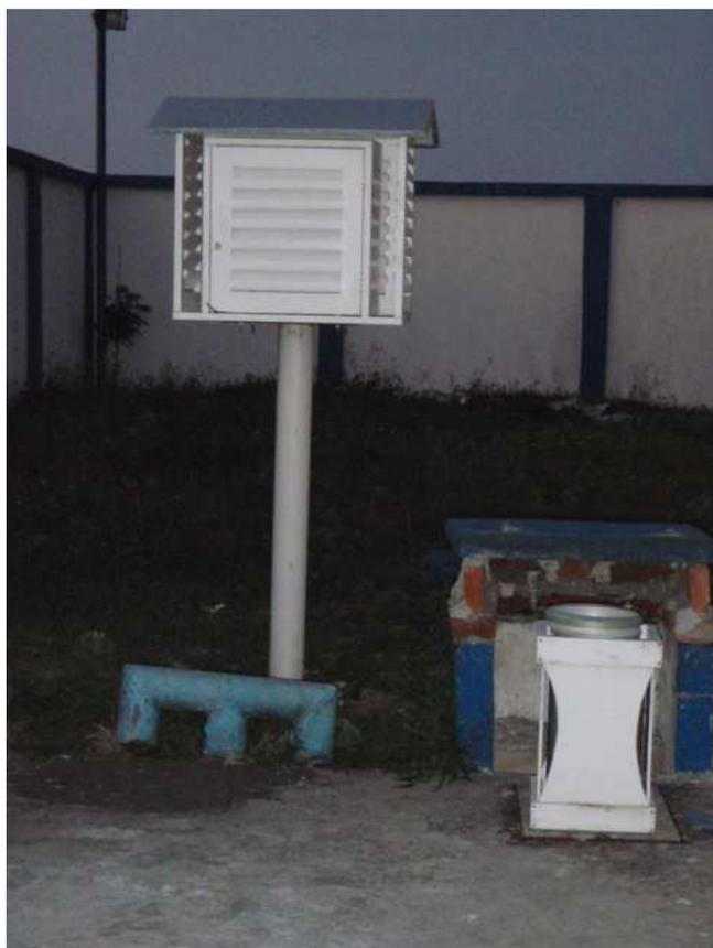
Vista del abrigo termométrico y el pluviómetro
