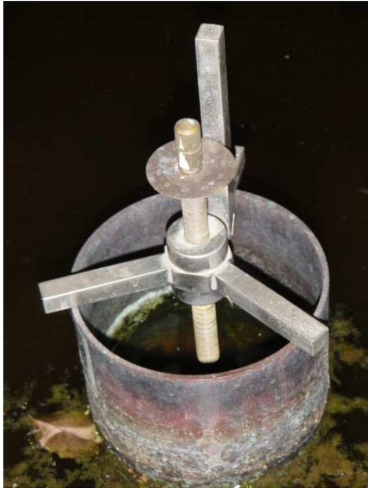
Vista del cilindro de reposo y el tornillo micrométrico
