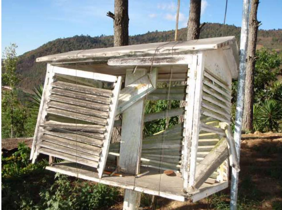
Vista del abrigo termométrico y del termómetro
