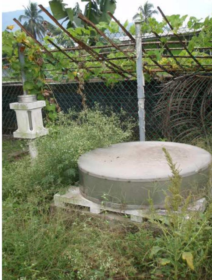
Pluviómetro y tanque de evaporación
