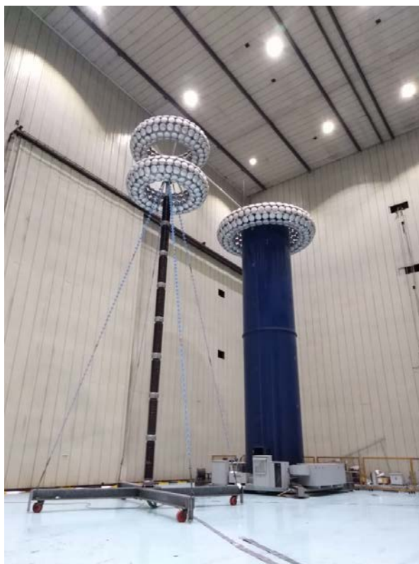
Generador de Impulsos Alta Tensión Generador de Impulsos Marca: Haefely, 24 pasos, con capacidad para generar implusos por rayo 1.2/50 us Impulso por maniobra 250/250us
