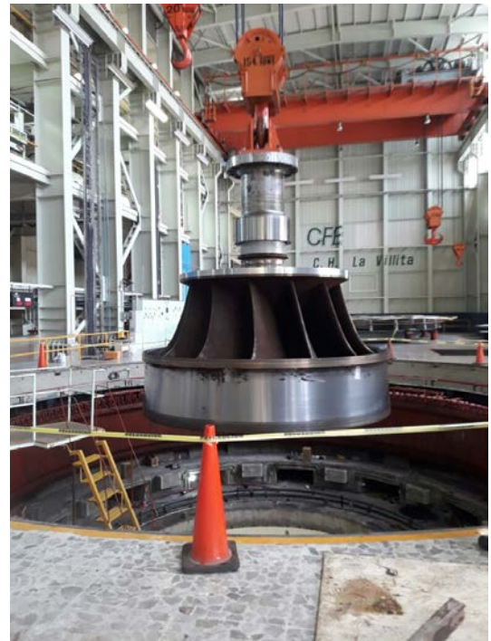
Reparación Rodete de Turbina CH La Villita
