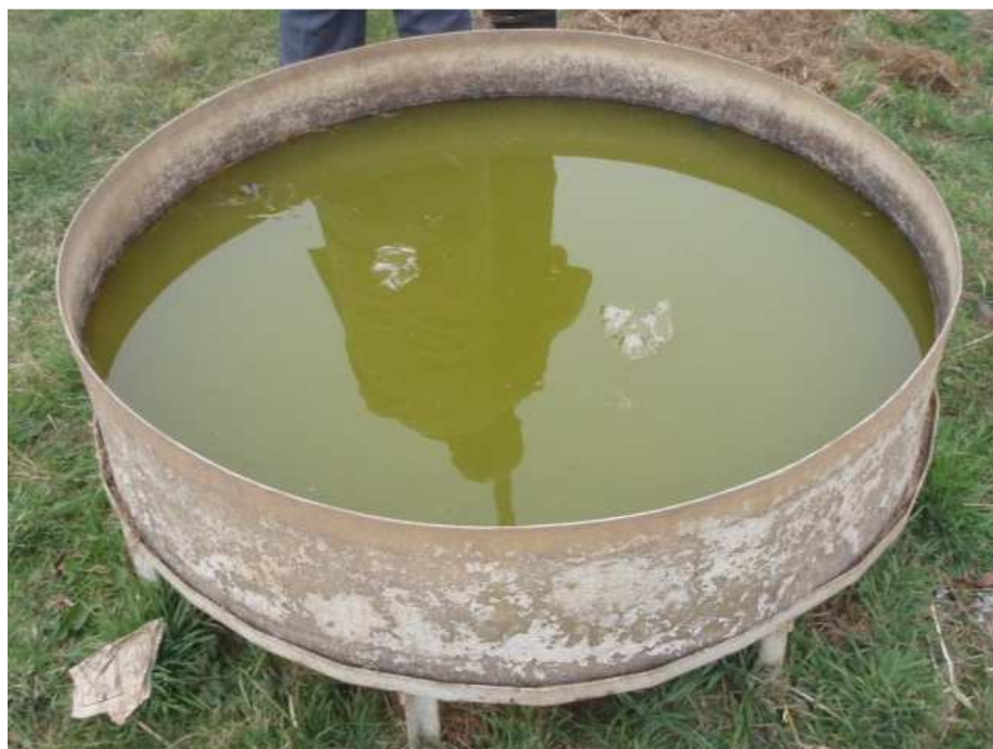
Tanque de evaporación
