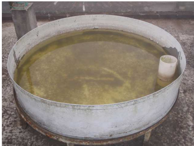
Tanque de evaporación
