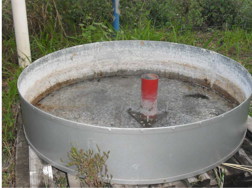
Tanque de evaporación
