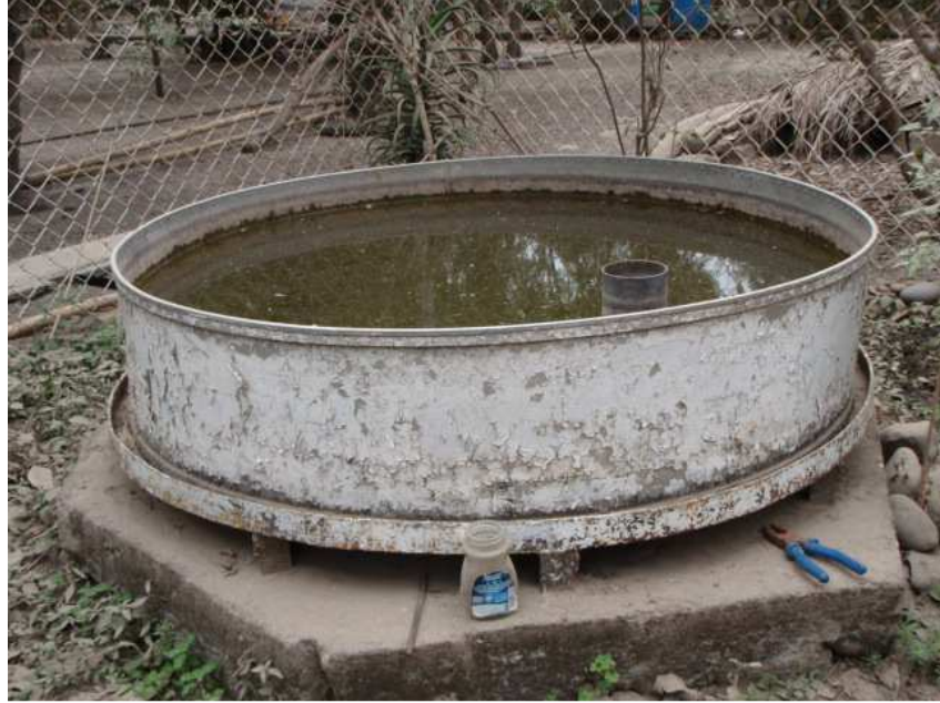
Tanque de evaporación
