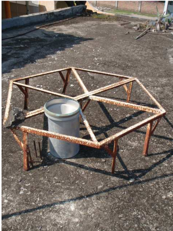
Base del tanque de evaporación y pluviómetro
