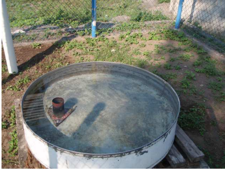
Tanque de evaporación
