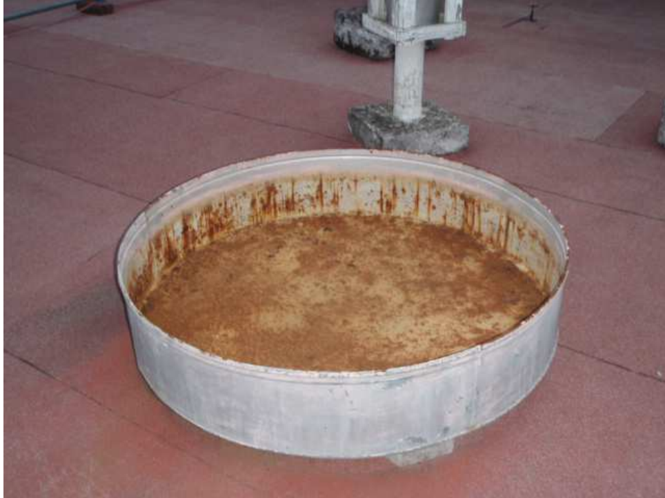
Tanque de evaporación
