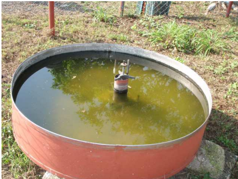
Tanque de evaporación
