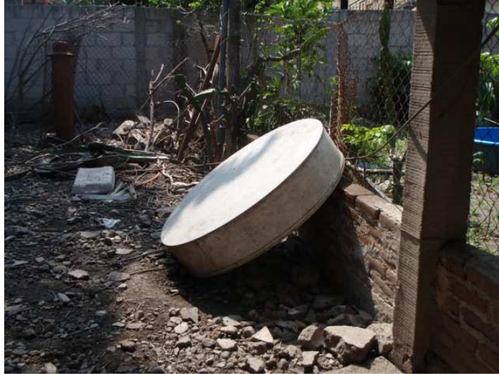
Tanque de evaporación
