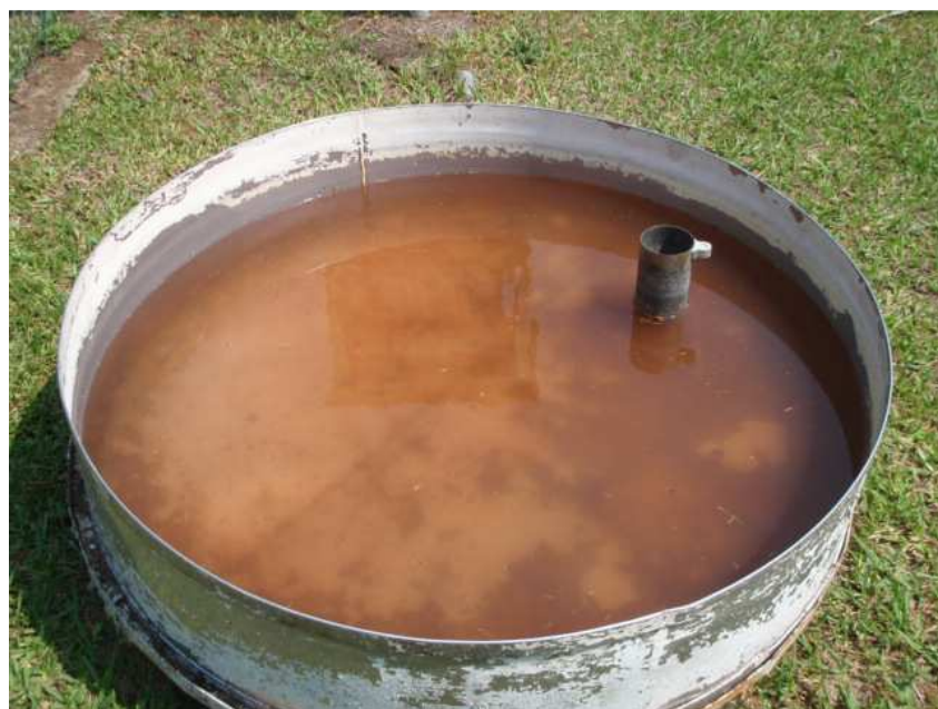
Vista del tanque de evaporación
