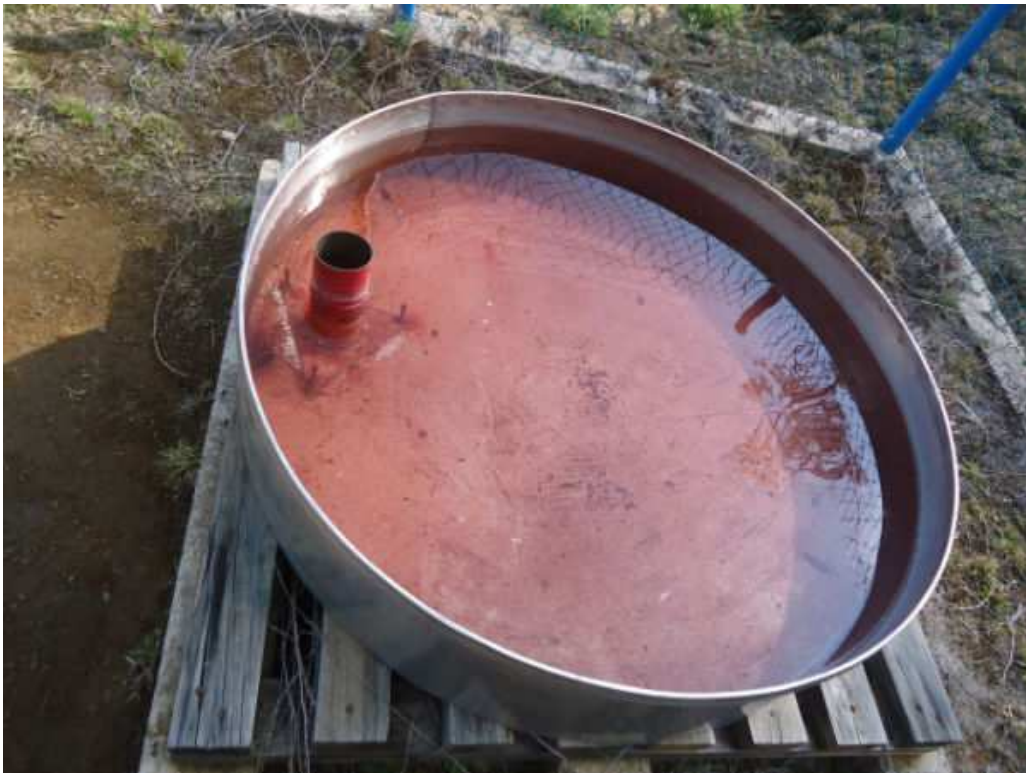
Tanque de evaporación
