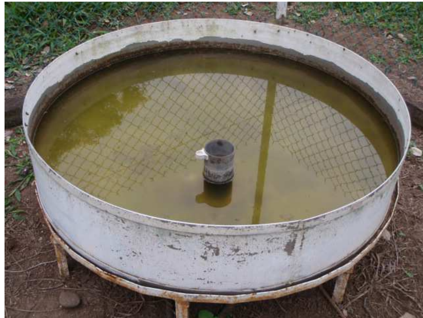
Tanque de evaporación
