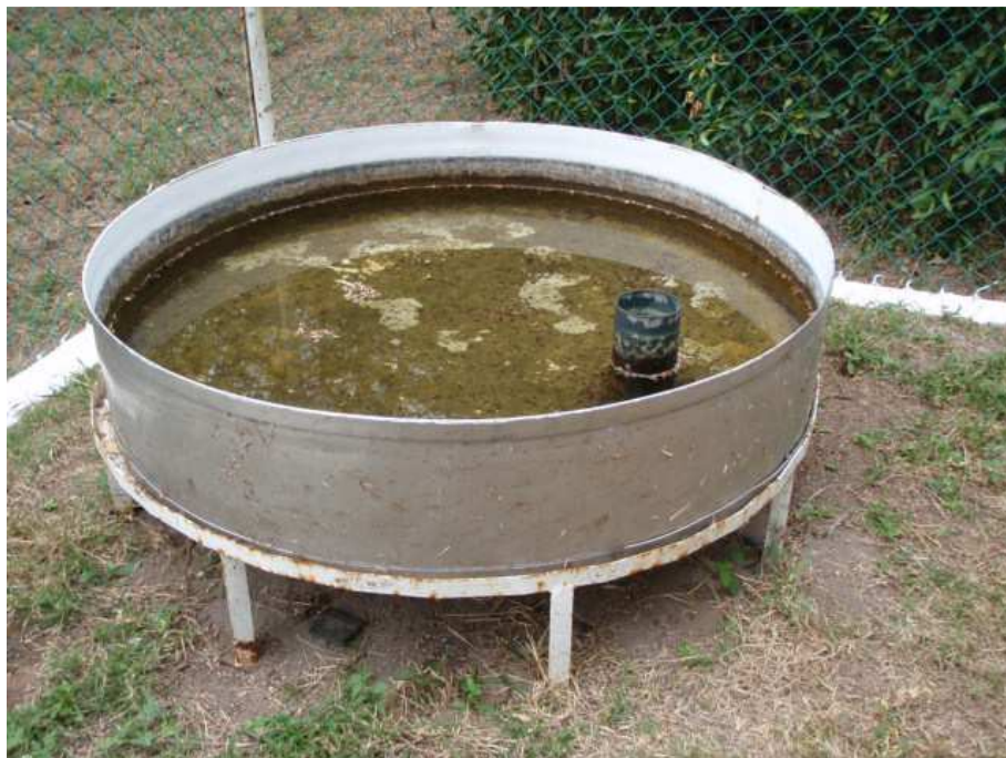
Tanque de evaporación
