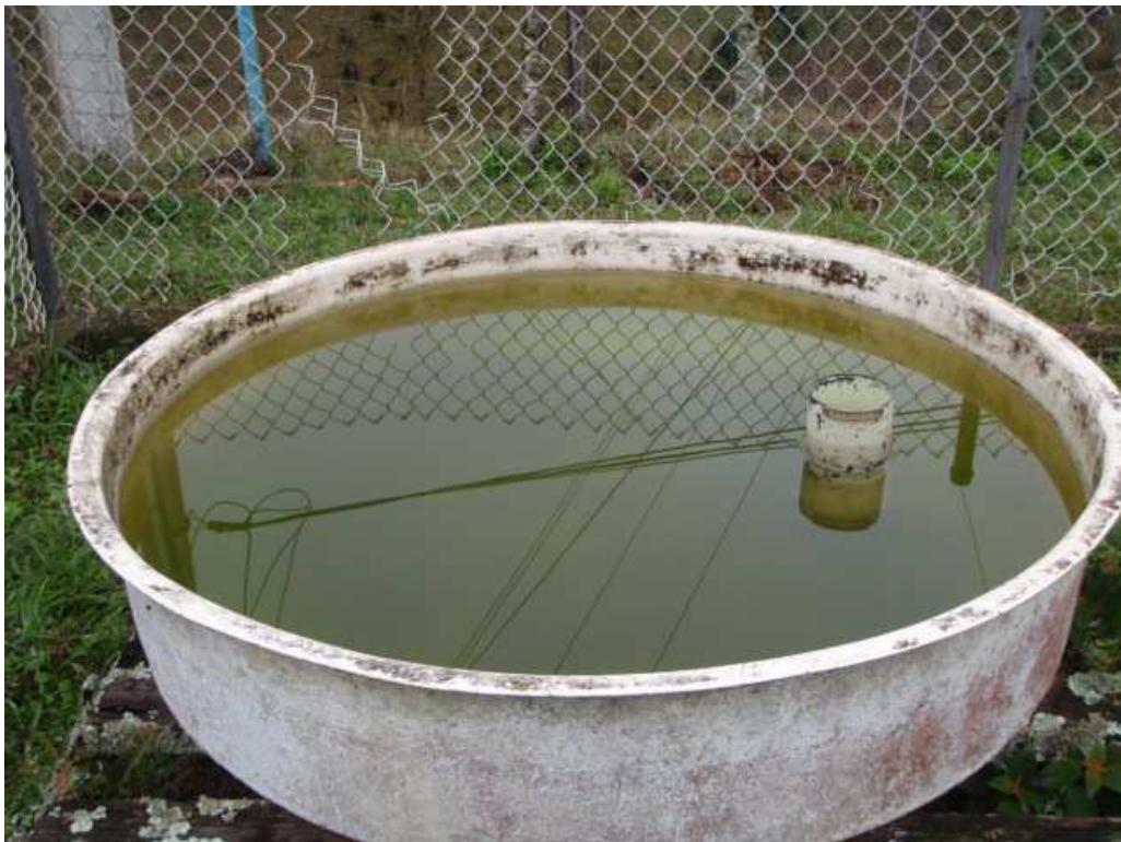
Tanque de evaporación
