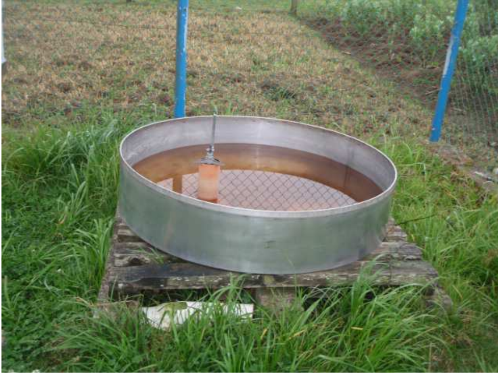
Tanque de evaporación
