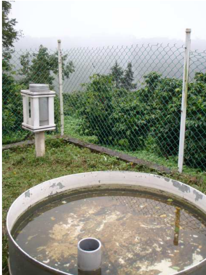
Tanque de evaporación y pluviómetro
