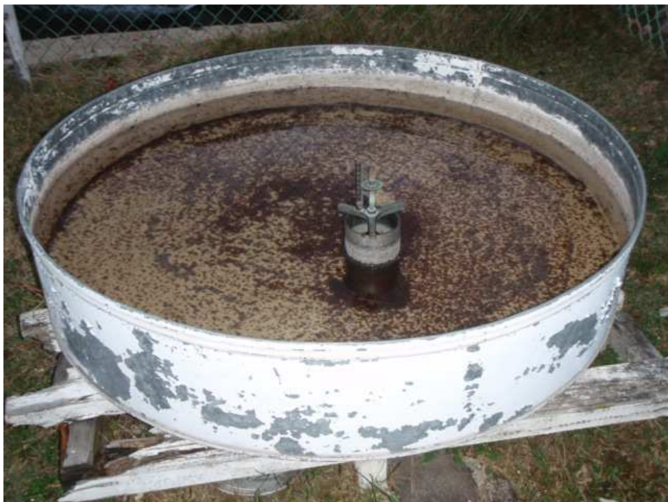
Tanque de evaporación
