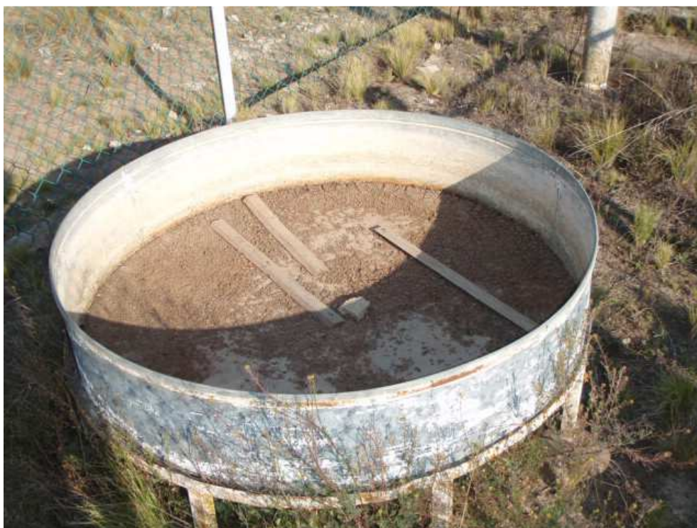
Tanque de evaporación
