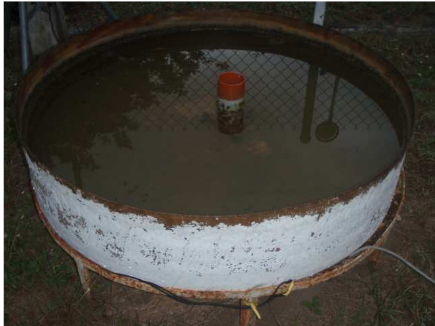
Tanque de evaporación
