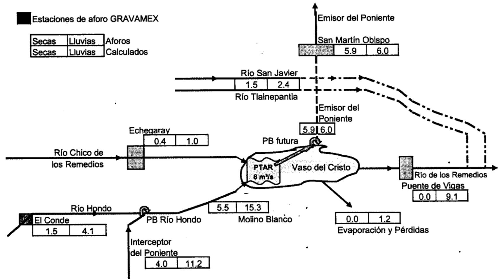
Fig. 7.- Balance de agua con una planta de tratamiento de 6 m³/s
