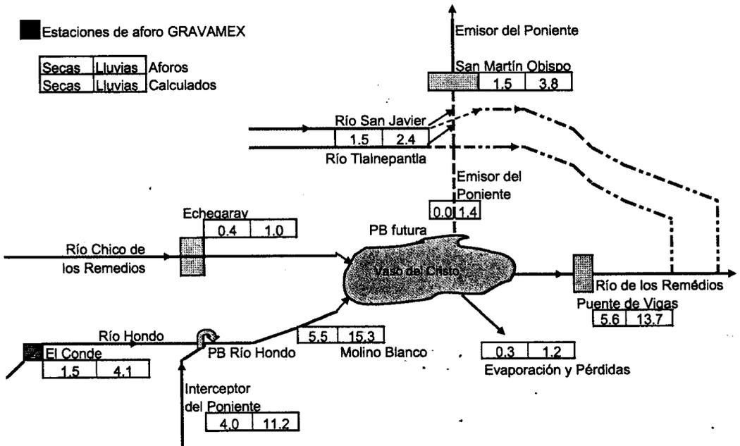
Fig. 2.- Balance de agua después de la construcción de la PB río Hondo
