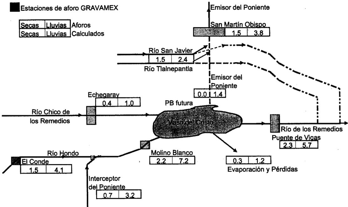
Fig. 1.- Balance de agua antes de la construcción de la PB río Hondo
